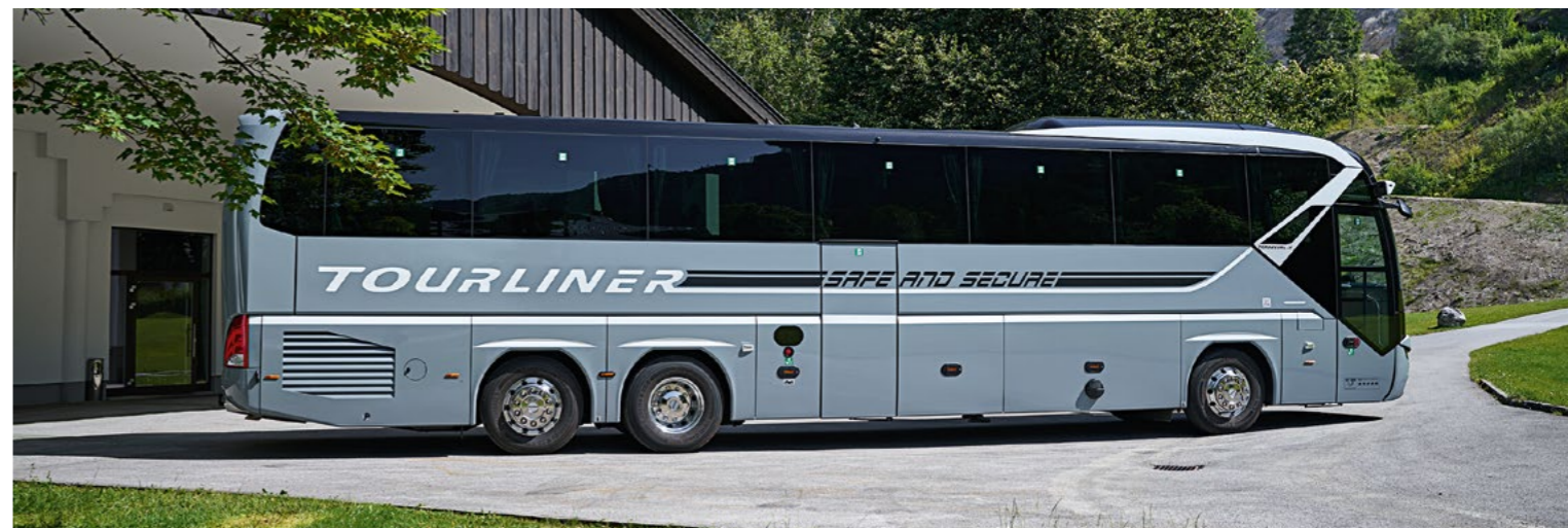
Der Neoplan Tourliner L: Trotz 14 m Länge ist er wendig, seine Nachlaufachse lenkt elektrohydraulisch mit.
