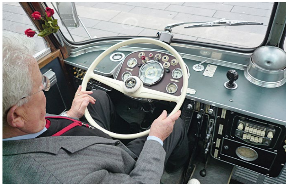
Setra-Cockpit aus den 50er-Jahren: großes Bakelit-Lenkrad, die nötigen Instrumente sind schon ordentlich gruppiert. Rechts das Mikro und genug Ablagefläche für den Reiseleiter.
