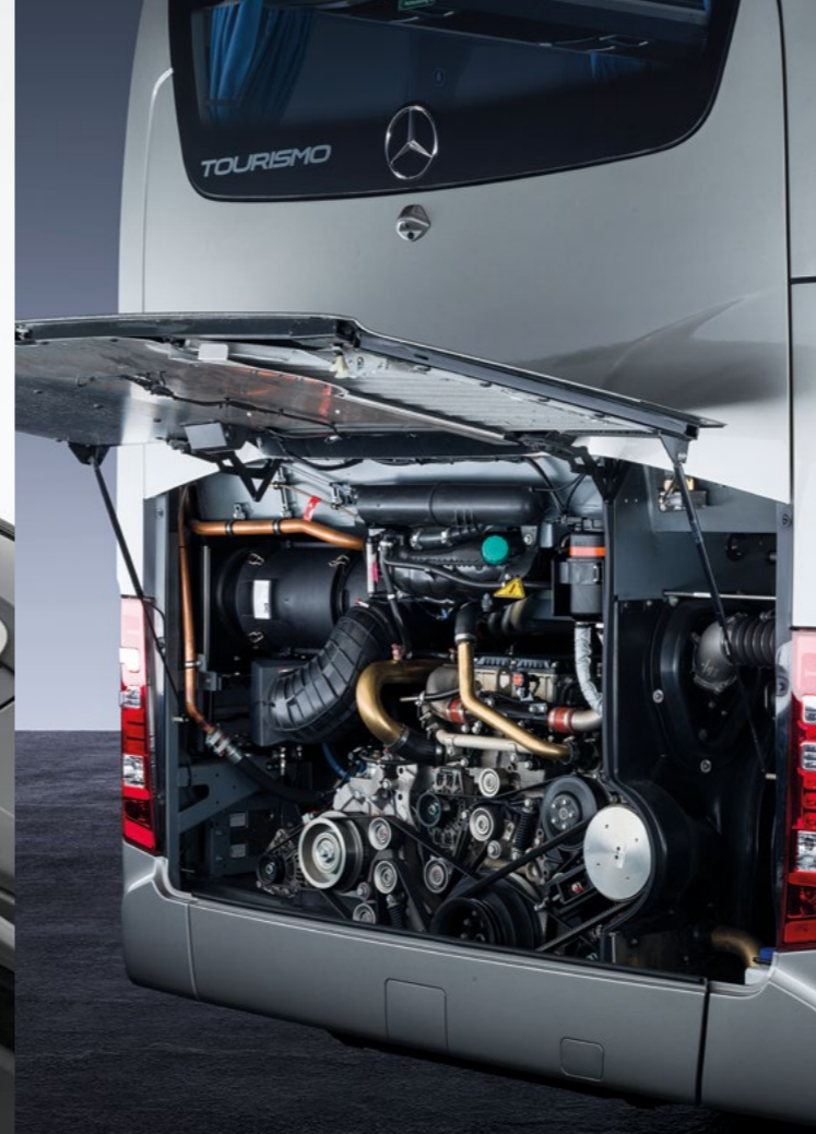
Angetrieben wird der Tourismo RHD von der neuesten Generation des Reihen-sechszylinders Mercedes-Benz OM 470 mit 10,7 l Hubraum.
