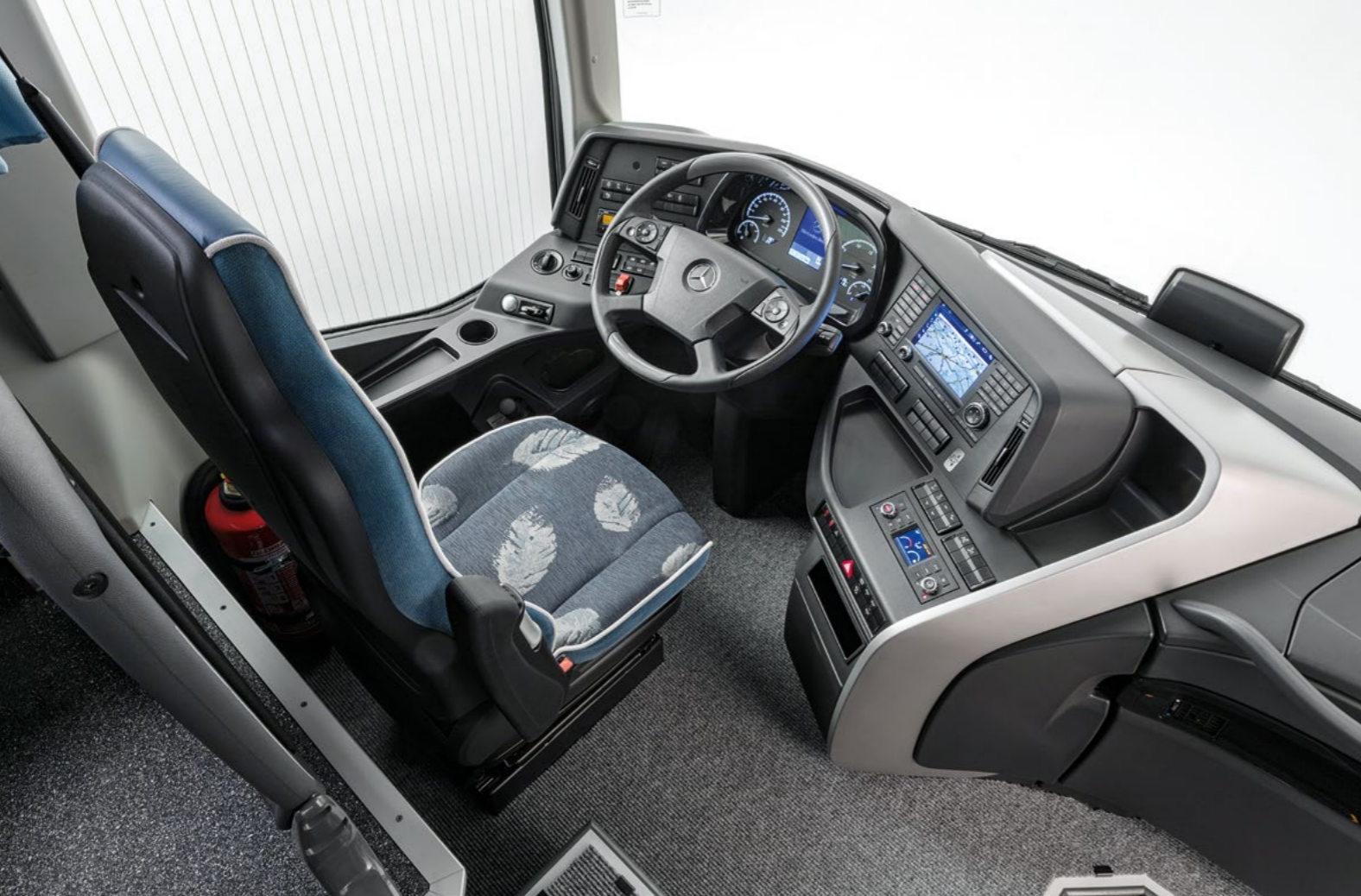
Ab sofort kann man sich zwischen zwei Cockpitvarianten entscheiden. Im Bild das „Cockpit Comfort Plus“, die Grundkonstruktion mit Multifunktionslenkrad und der neuen Instrumentenanlage mit farbigem TFT-Display ist.
