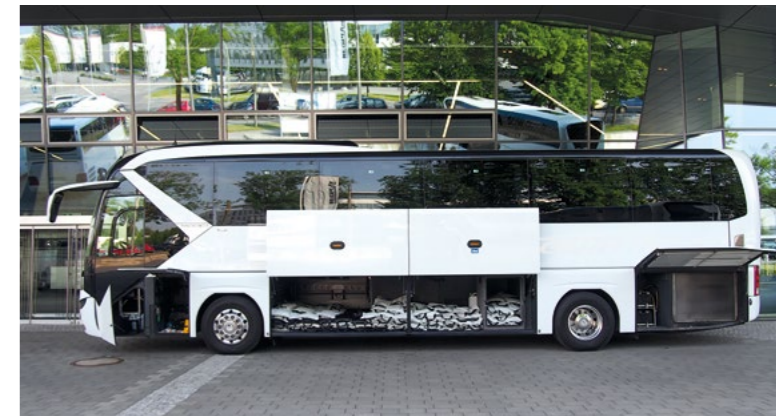
Klappen auf: Ausreichend Kofferraum mit 9,7 m³, die Batterien sitzen hinten links.
